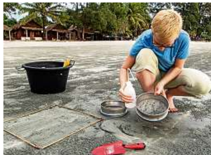
In jeweils 50 mal 50 Zentimeter großen Bereichen wird der Sandstrand auf kleinste Plastikteilchen hin untersucht.
